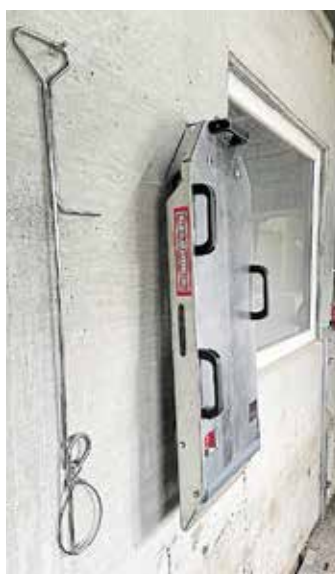
Platzsparend hängt das Rollbrett an der Wand. Die Zugstange kann auch in die Griffe gelegt werden.
